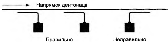
Рис. 2.7. Розміщення зростків у мережах детонуючого шнура залежно від напрямку детонації
