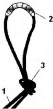
Рис. 2.25. Запобіжна петля на ділянці зрошення саперного проводу: 1 – провід; 2 – зрошення; 3 – вузол
