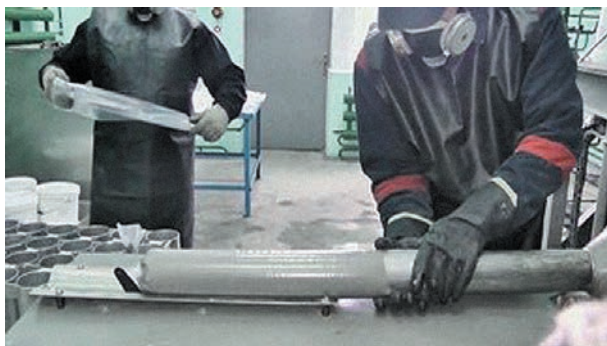
Фото 10. Процесс изготовления зарядов «Эмульсена – ГА-90» марки 1
