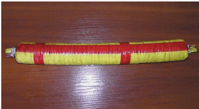
Фото 27. Заряд эмульсионного патрона «ЗЭП»
