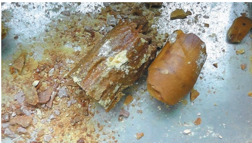
Фото 21. Тротил -У, полученный от утилизации боеприпасов
